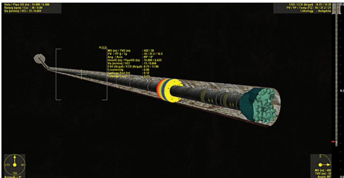
A AJ Lucas em agosto de 2017, completo os dois furos pilotos de 12,5" (318mm) para a linha de retorno do fluido e para a linha principal, ocasião em que constataram que as pressões de circulação calculadas pelo software virtualmente, bateram com as pressões registradas na prática.
