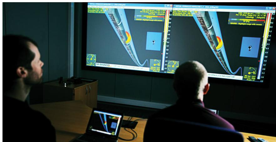
Para se uma certeza das pressões de circulação para limpeza do furo, foi utilizado um software que permitiu a predição do risco de hidrofratura. Esse software foi projetado para avaliar as situações hidráulicas críticas de um fluido de perfuração, numa simulação, com múltiplos cenários, permitindo avaliar as propriedades dele, as taxas de vazão, de penetração, e a garantia de que os cortados seriam **removidos rapidamente** de maneira a manter o furo limpo e estável.
